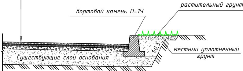
ПРИМЫКАНИЕ ДОРОЖНОЙ ОДЕЖДЫ К СУЩЕСТВУЮЩЕЙ НАРУЖНОЙ СТЕНЕ
